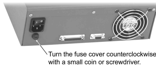
Figur 12: Ersetzen der Sicherung
